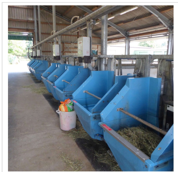
Abbildung 11: Stationäre Futter-Wiege-Automaten mit automatischer Tiererkennung sind heute Standard bei der exakten Erfassung der Futteraufnahme in Laufställen (Foto: Brade)
