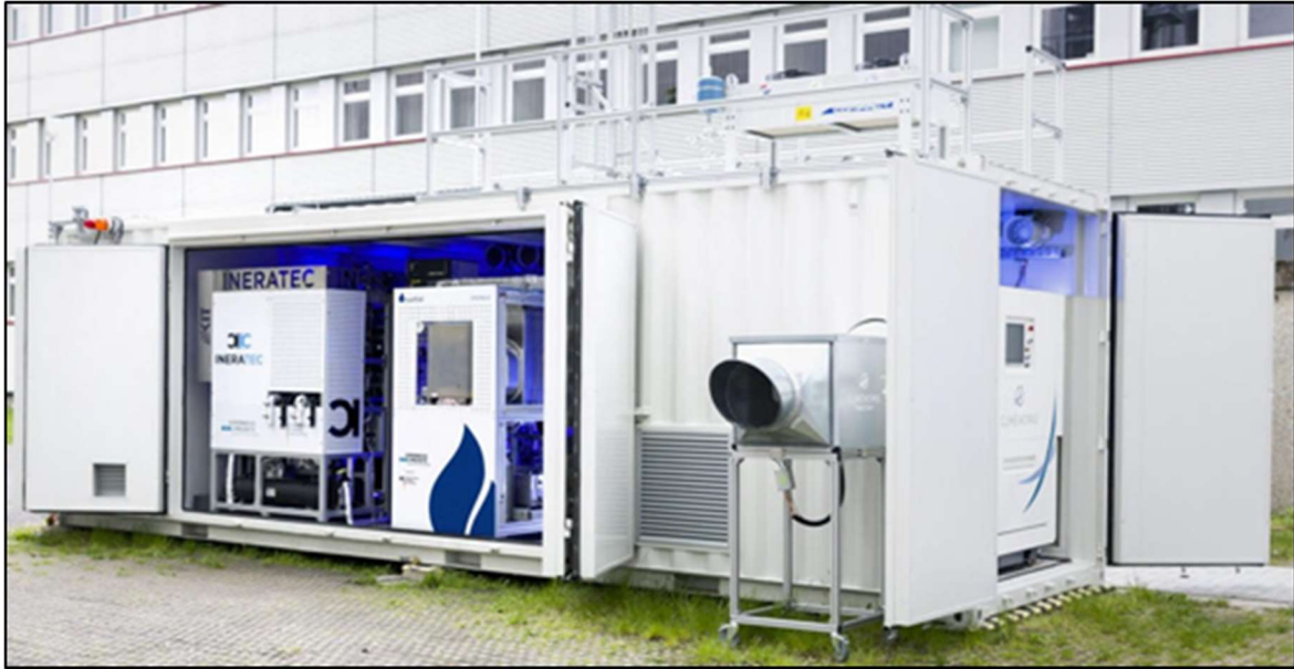
Abbildung 4: Containeranlage zur Produktion von synthetischem Kraftstoff am KIT Quelle: KIT (2019)
